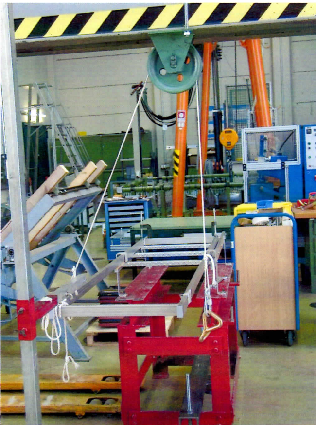
Bild 2: Versuchsaufbau für die Belastung unter 30° in Messpunkt 2
